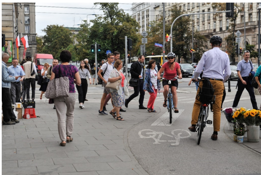
Zdjęcie 7 ul. Waryńskiego, rejon wyjścia z metra. Zastosowanie oznakowania poziomego nie wpływa na poprawę warunków ruchu pieszego.
